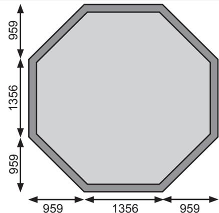
Fundamentplan (in mm) bei Aufbau mit Fußboden:
